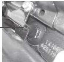
Filtro de aceite en el medio cárter izquierdo (hexagonal 24 mm.)
